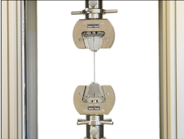
Keil-Probenhalter Typ 8504, Fmax 100 kN bis 250 °C
