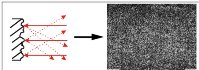
Ein Speckle-Muster wird an der Probenoberfläche durch Laserlicht erzeugt
