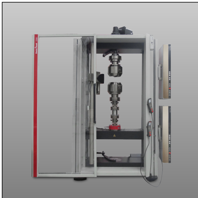
Stand-Prüfmaschine mit Torsionsantrieb und eingebauten Probenhaltern
