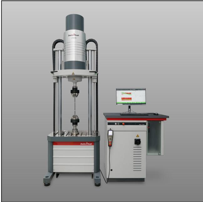
Elektro-dynamische Prüfmaschine LTM 10 Torsion
