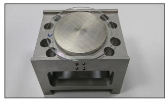
Stahl-Probenhalter für 1 großen Probeneinsatz Ø 50 mm
